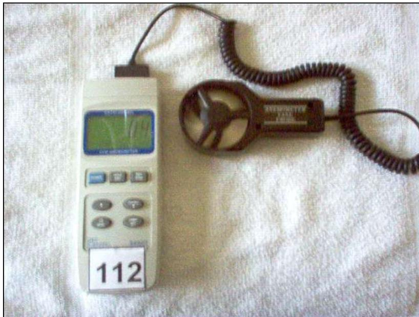
Foto N° 9 – Vista General del Anemómetro utilizado en las mediciones
