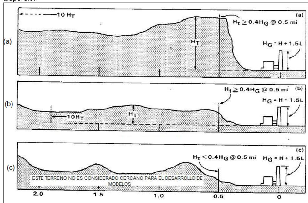
Fuente: EPA. Junio 1985. Guía para la determinación de la altura de la chimenea. Aplicación de Buenas Prácticas de Ingeniería. (Documento técnico de soporte para regular la altura de la chimenea).
