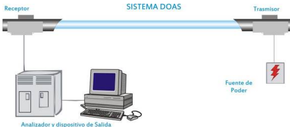
Figura 17. Representación esquemática de un Sistema DOAS (Differential Optical Absorption Spectroscopy) 85
