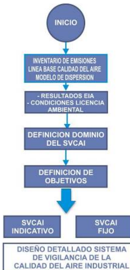
Figura 2. Diagrama de flujo para el diseño SVCA para actividades industriales
