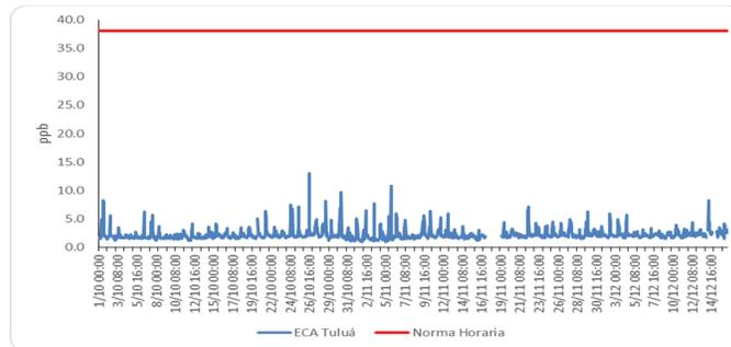
No hubo excedencias de las normas para el SO<sub>2</sub>, NO<sub>2</sub> y ozono en los puntos monitoreados.
