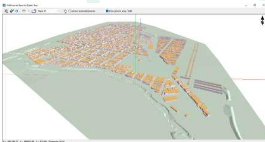
**Figura 17. Modelo tridimensional de montaje de curvas, receptores (Edificaciones) y fuentes móviles (Carreteras).**
