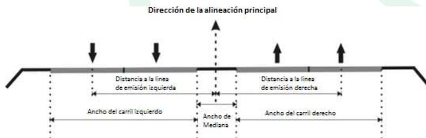
**Figura 6. Corte transversal del perfil de la vía.**
