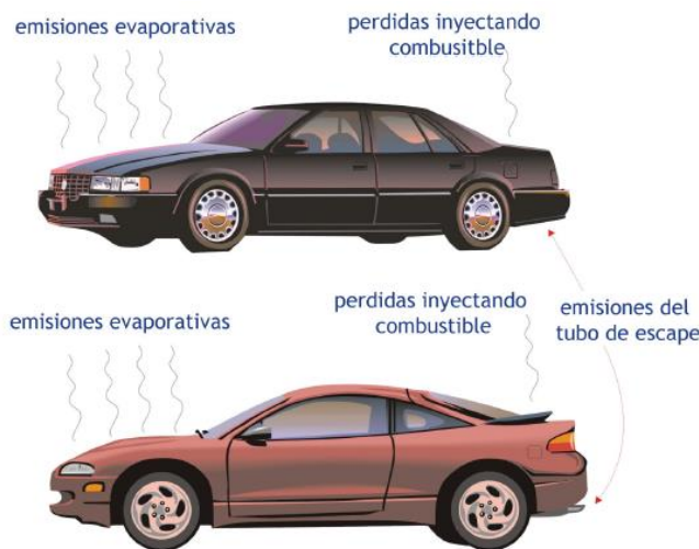
Figura 3.5 Emisiones presentes en los vehículos Fuente: MADS (Manual de Fundamentos y Planeación Inventarios de Emisiones)
