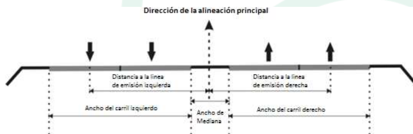
Figura 6. Corte transversal del perfil de la vía.
