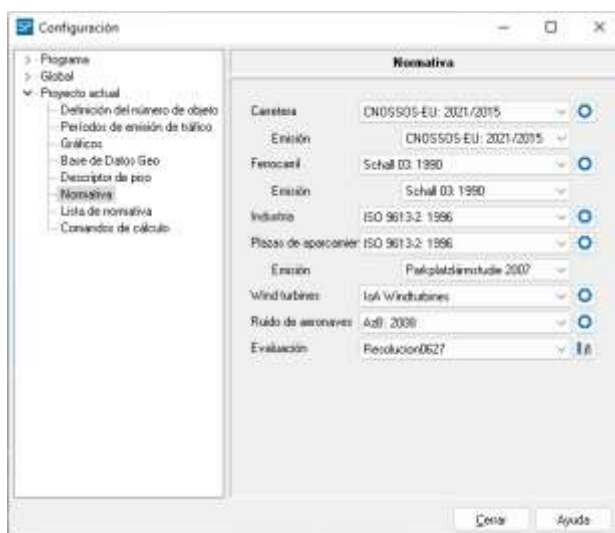
Figura 19. Normativas y estándares utilizados en la simulación de ruido ambiental para el desarrollo de los MER.
