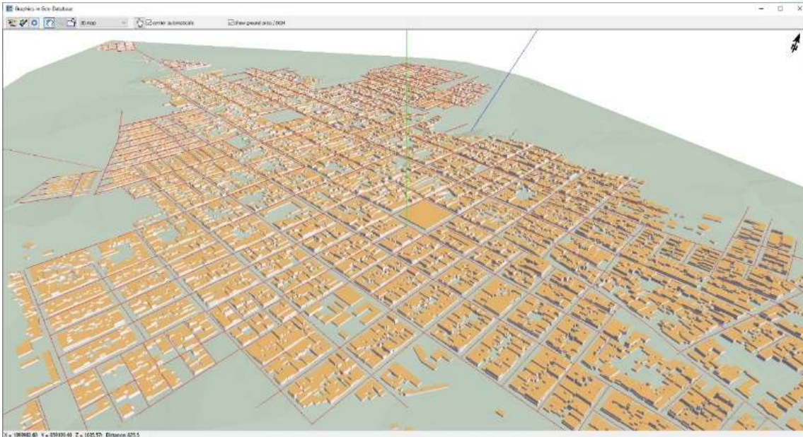
Figura 18. Modelo tridimensional de montaje de curvas, receptores (Edificaciones) y fuentes móviles (Carreteras).
